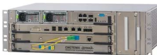
Рис. 3. Интегратор системы DAS "Дунай"
